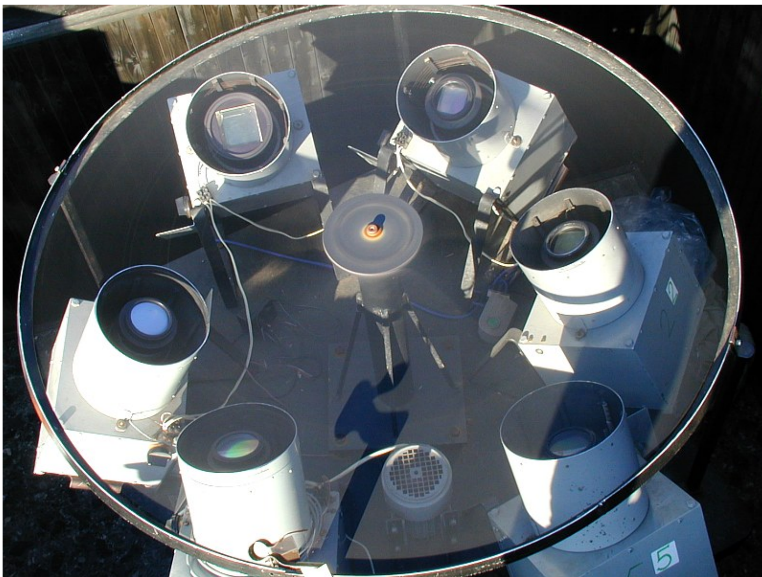
Baterie šesti fotografických kamer s mřížkou a rotujícím sektorem v Ondřejově
